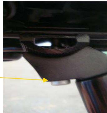
Régler l'inclinaison de la selle, afin d'obtenir la position la mieux adaptée à votre confort. Resserrer l'écrou, couple de serrage maxi 13 Nm.
