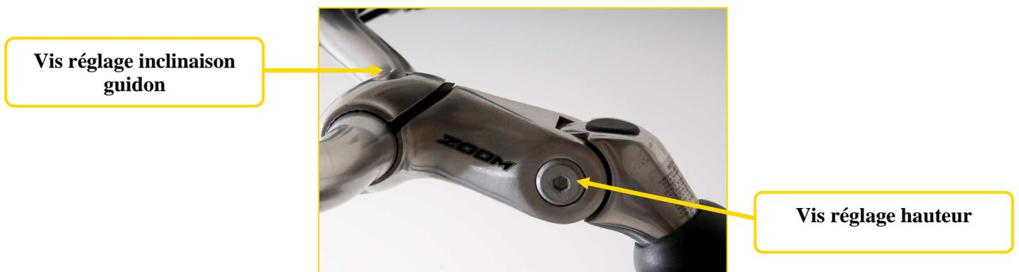
Faites de même avec la seconde vis pour le réglage de l'inclinaison de votre guidon. Après réglage, resserrer énergiquement les vis, couple de serrage maxi : 19.6 Nm.
