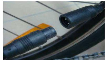
Couper le lien « Colson » de fixation du câble moteur sur cadre. Retirer les caches écrous de roue droit et gauche. Desserrer les écrous. Sortir les écrous et rondelles d'axe de roue. Desserrer le serre câble du frein V Brake afin de libérer les patins pour pouvoir enlever la roue.
