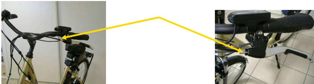
Desserrer le serre-câble et tirer sur le câble jusqu'à ce que les patins touchent la jante. Resserrer le serre-câble (une attention particulière est à apporter à chaque extrémité de la gaine qui doit entrer sans forcer dans le logement de chaque embout rigide, côté poignée de frein et V-Brake).
