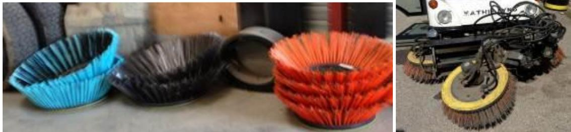
Figure : Photo de gauche : différents types de brosses (métalliques au centre et mixte sur les côtés) – Photo de droite : sur laquelle s'adaptent ces brosses
