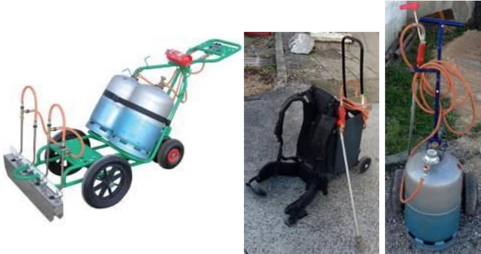
Figure : Désherbeur thermique à flamme – photos de gauche : conducteur marchant, centre : porté, photo de droite : trainé
